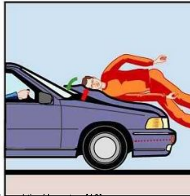
Obr. 11 Srážka chodce a automobilu s aktivní kapotou [10]
