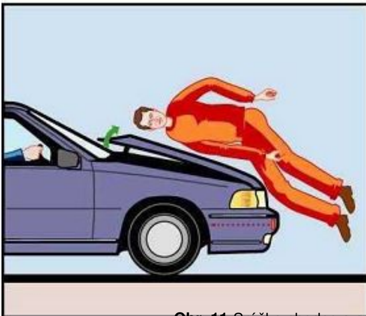
Obr. 11 Srážka chodce a automobilu s aktivní kapotou [10]
